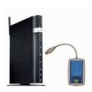
Sabianet è un sistema di controllo centralizzato di una rete di terminali idronici Sabiana MB basato su di un software che lavora in ambiente LINUX™ (il programma è già installato sul PC) e funziona in modalità stand alone, come un classico computer, ed è quindi collegabile ad un monitor, ad un mouse e ad una tastiera.
